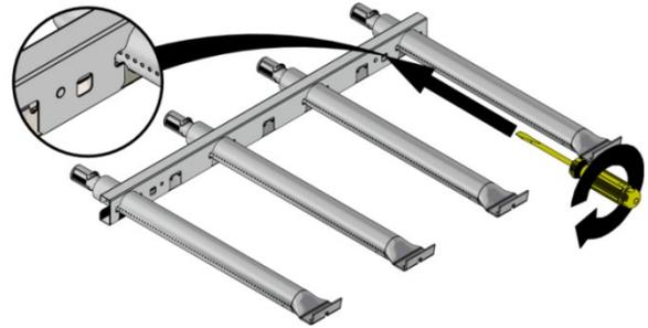
3. Pulire i tubi venturi con un pulitore per pipa o con l'apposito utensile per la pulizia dei tubi Venturi (Accessorio n.77310).
